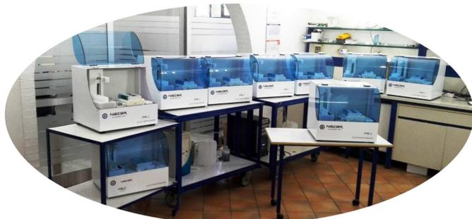
*Sistema per Elettroforesi su Acetato di Cellulosa in cui tutte le fasi di lavoro sono realmente automatizzate, incluso il caricamento di un liquido di lavaggio per gli applicatori*
